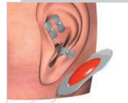
L'unità di stimolazione P - S T I M viene fissata dietro l'orecchio con un elettrodo autoadesivo.
